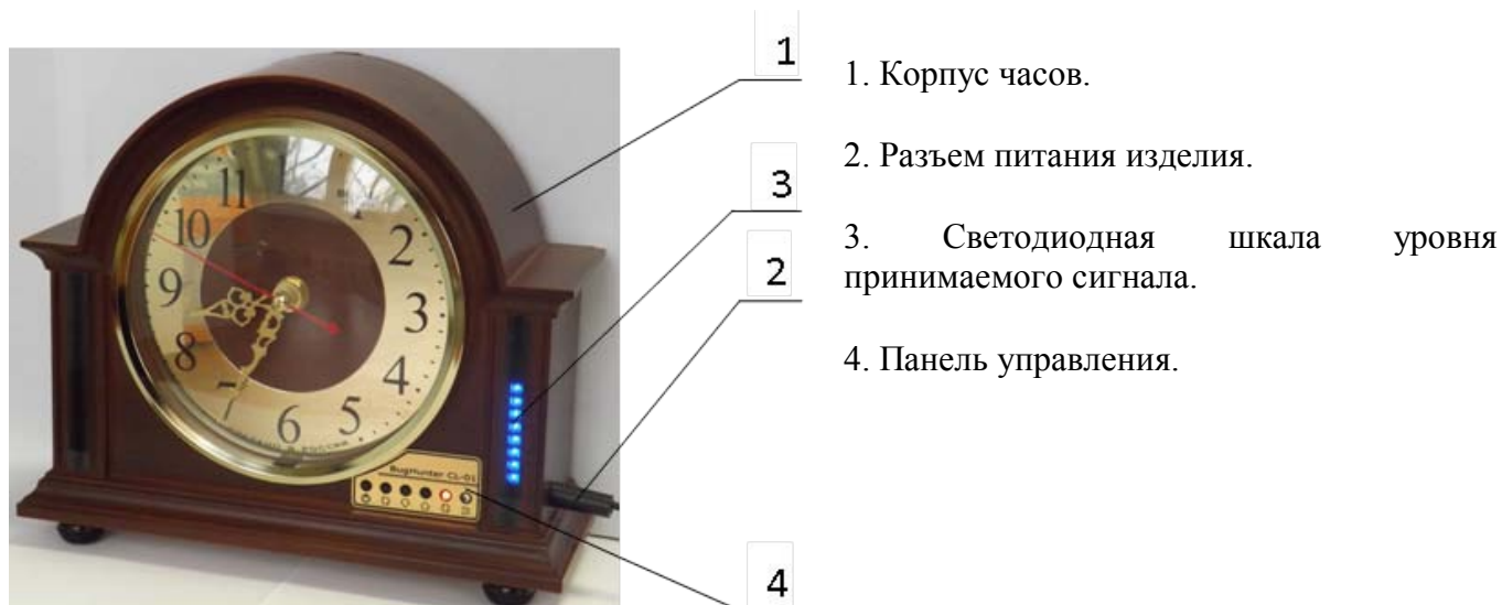
Рисунок 2 – Внешний вид и расположение составных частей изделия
